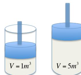
Figura 5-23 Expansión de un pistón para producir trabajo (W)
